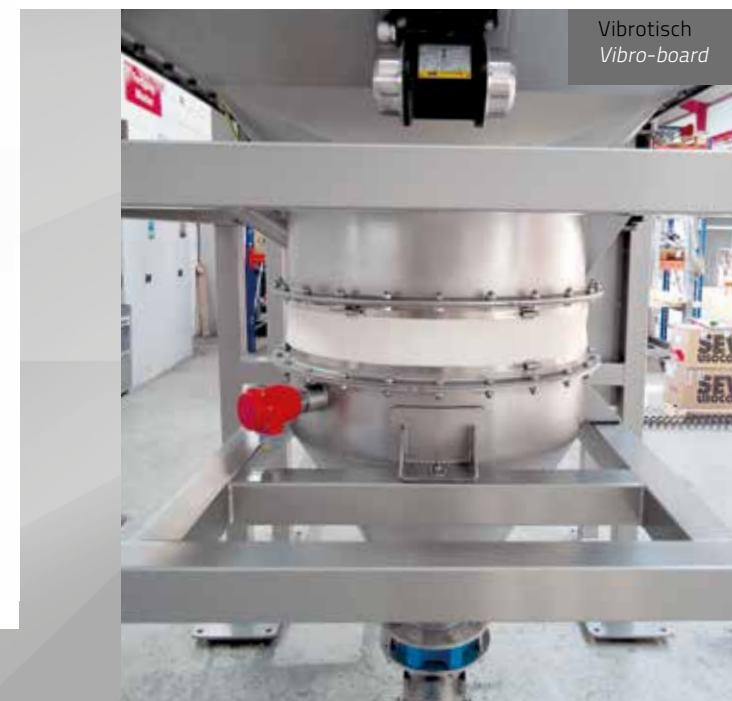
Big-Bag Entleerstation mit Gabelstapler-Ladegericht Big-Bag discharge station with loading gear for forklift
